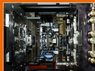
Entnahme der Fertigteile und Bestückung mit Pins im vollautomatisierten Prozess
