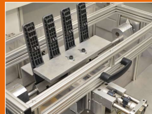
Langzeittest für ein 2K-Produkt, bestehend aus einem Filmscharnier und einer steifen Platte
